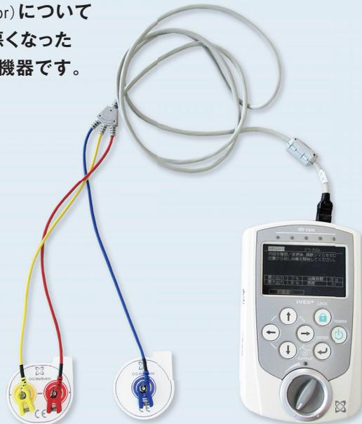
【パワーアシストモード】IVESの大きな特徴として、電気刺激を用いて麻痺がある方の筋力をアシストします。人が手足を動かそうとすると、脳から神経を通して筋に運動指令が伝わります。そして筋が収縮して運動を起こします。その際に筋にも微弱な活動電位が発生します。IVESはその微弱な筋活動電位を読み取って、目標とする筋に電気信号を送り動きのアシストします。IVESについているLEDランプで、発揮した力を簡単に確認できます。安静時には電気刺激による筋収縮は生じない為、「休みたい時に休む」事が可能となっており、そのため「長時間の使用が可能」です。
